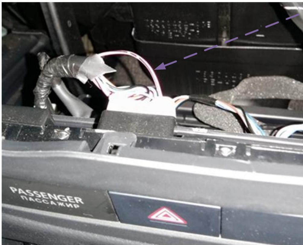
Рис. 15 Подключение управления аварийной сигнализацией
