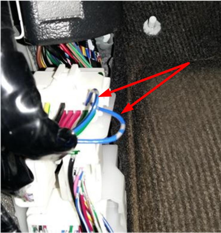
Рис.19 Подключение ц.з «по силе»
