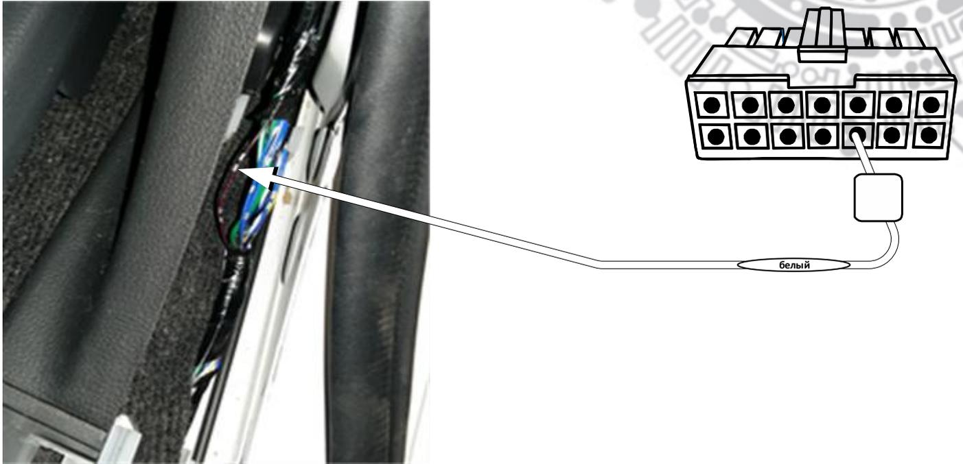
Рис.23 Подключение имитации открывания двери водителя
