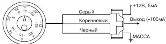
Проложите провода, оканчивающиеся 3-контактным разъемом, от датчика температуры SCHER-KHAN TE-1 к процессорному блоку системы запуска двигателя или СТСТС с блоком запуска двигателя.
