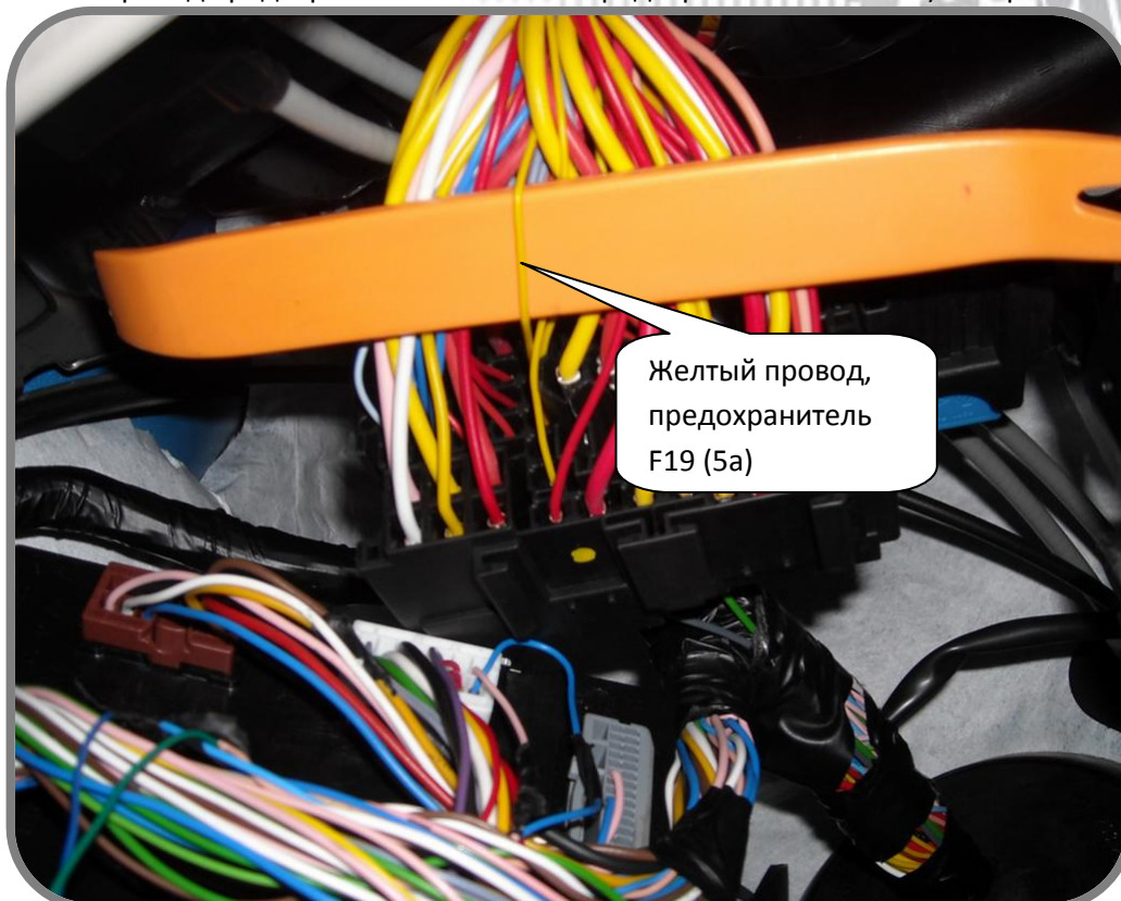
Рис. 9: –Цепь питания блока впрыска.
