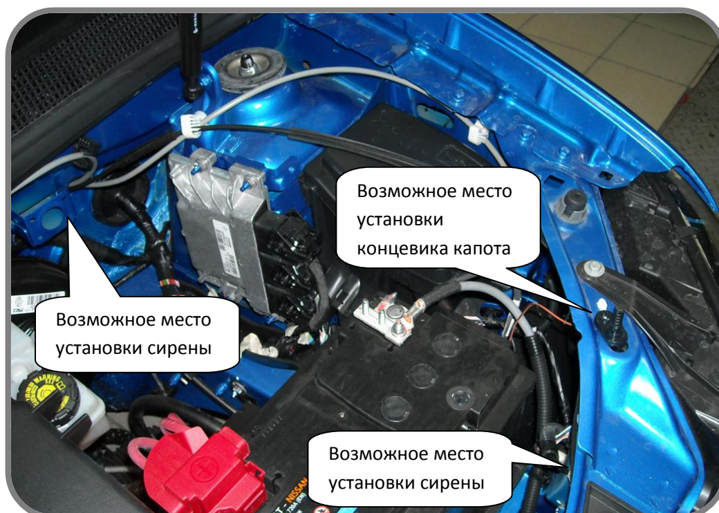
Рис. 11: – Возможное место установки концевика капота и сирены.
