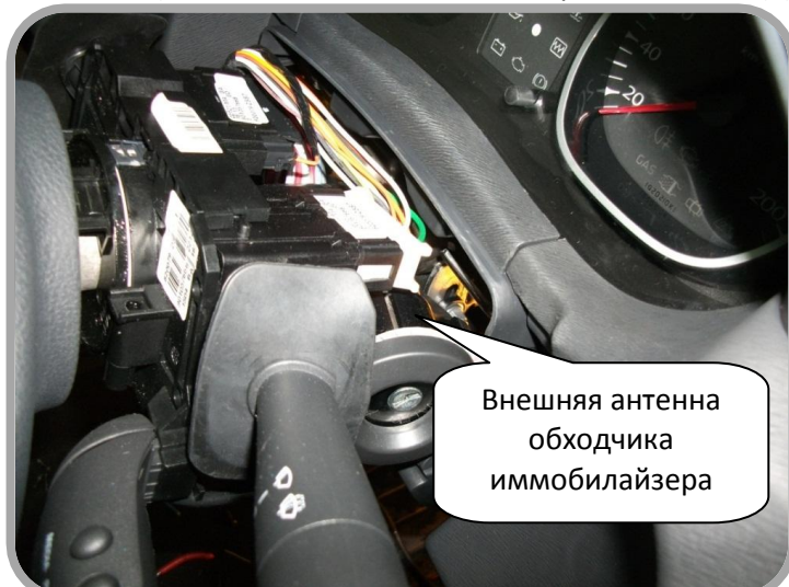
Рис. 6: – Внешняя антенна обходчика иммобилайзера.
