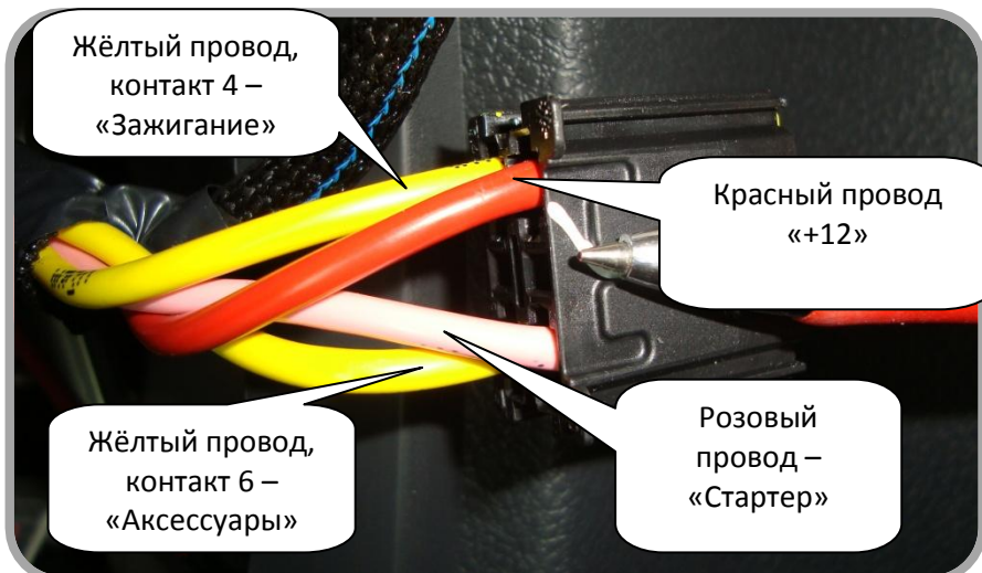
Рис. 5: - Подключение цепей автоматического запуска.
