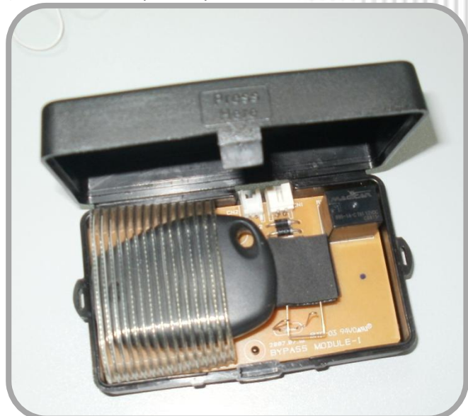
Рис. 7: – Размещение ключа зажигания в блоке обходчика иммобилайзера.
