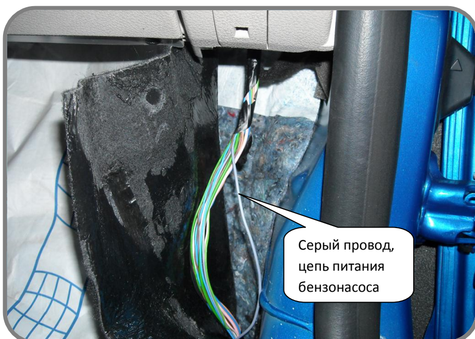
Рис. 8: –Цепь бензонасоса.
