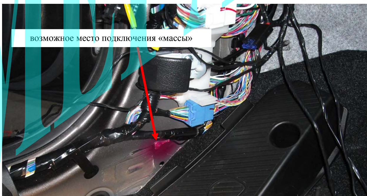
Рис. 3: Подключение «массы».
