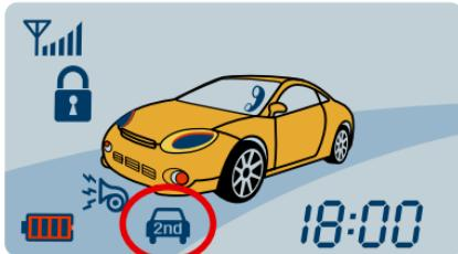
Теперь Вы можете полноценно управлять вторым автомобилем. Для возврата в режим управления первым автомобилем нажмите кнопки (I+II) брелока на 2 сек. Вы услышите два коротких сигнала брелока, символ
