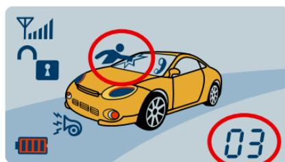
Если в режиме охраны система срабатывала только от датчика вызова владельца, то при снятии с охраны система сообщит об этом миганием
